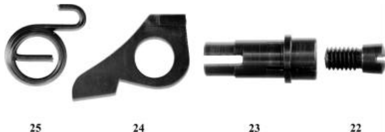
Die Konstruktion, mit der das Abzugsgewicht nur mit einem Schraubendreher von außen eingestellt werden kann, besteht aus vier Teilen
