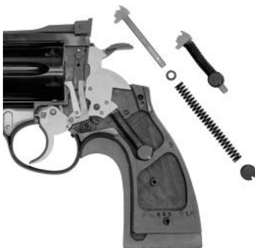
In dieser Serie wurde endlich die Führung der Schlagfeder so verändert, dass diese, nachdem ein Stahlstift eingesetzt wurde, im gespannten Zustand entnommen werden kann
